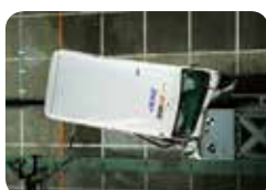
オフセット(部分) 前面衝突試験
