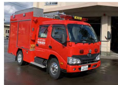
11月21日(大安)、厚沢部消防署鶏分遣所(鶏町)に新しいポンプ車が納車されました。これまでのポンプ車は昭和58年に納車され35年が経過。老朽化が進んできたことから更新となりました。新ポンプ車には、水と薬液を混合し圧縮空気を送り込み泡状にして放水できる『圧縮空気法消火装置(CAFS)』が導入され、水だけの場合と比べて5〜20倍の消火効率が得られます。なお、CAF S機能が付いた車両は厚沢部町では初めての配備となります。
