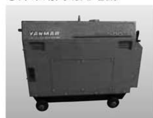
非常用に20kWットの簡易発電機を配置
