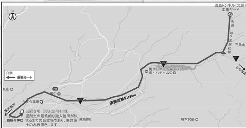
工事で発生する残土は町有地（鶉）に仮置きします。渡島トンネル町内工区で発生する残土のうち対策を要しない土（無対策土）は鶉にある町有地に仮置きします。残土運搬は大型ダンプを用いて国道227号線（ルート）は左図参照）を走りますので交通事故が起きない起さないよう皆様の協力もお願いします。
