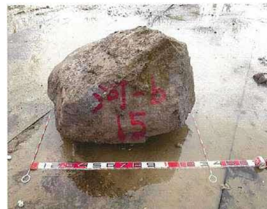
調査箇所を確認された岩塊 (約1300mm×1000mm×800mm、約2500kg)
